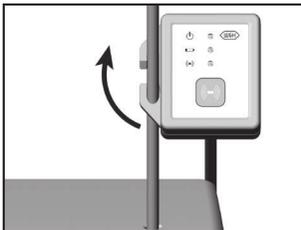
❷ Fixieren Sie den SPI-Dongle am Stativ oder nehmen Sie den SPI-Dongle vom Stativ ab.
