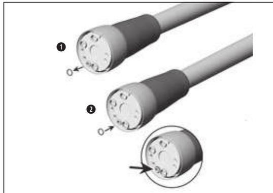
**!** Ersetzen Sie beschädigte oder undichte O-Ringe sofort. Verwenden Sie kein scharfes Werkzeug!
