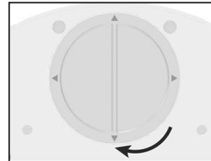
4 Verriegeln Sie das Batteriefach.
