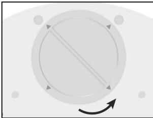
1 Öffnen Sie das Batteriefach.
