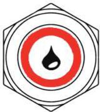
Taster der WTE leuchtet konstant rot. Kundendienst sofort rufen! Die Behandlungseinheit am Hauptschalter ausschalten! Der Überlaufsensord hat ausgelöst! Es liegt eine Fehlfunktion des Füllstandssensors und/oder des Arbeitsventils vor.
