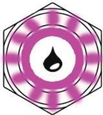
Taster der WTE blinkt magenta. Die WTE stoppt! Füllvorgang des zugeführten Wassers zu langsam. Die WTE durch 8 Sekunden Tastendruck zurücksetzen und mit kurzem Tastendruck neu starten. Wiederholt sich das Magenta-Blinken, rufen Sie den Kundendienst.
